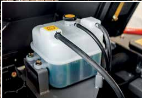
Paisuntasäiliön uusi sijainti estää moottorin ylikuumenemisen.
