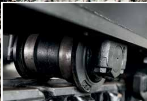
Vahvistettu holkkimateriaali parantaa kulumiskestävyyttä.
