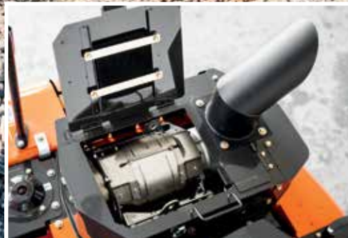
SCR-järjestelmä pienentää päästöjä ja melua.
