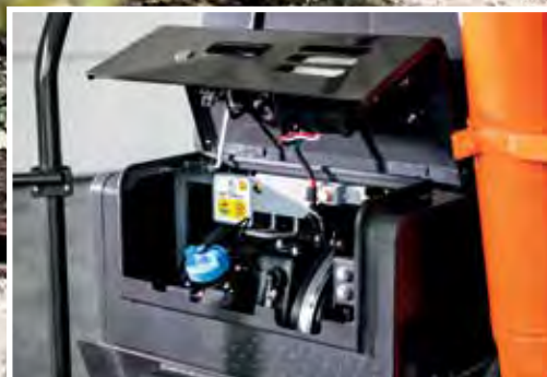
Ureaa ruiskutetaan pakokaasuun päästöjen vähentämiseksi.
