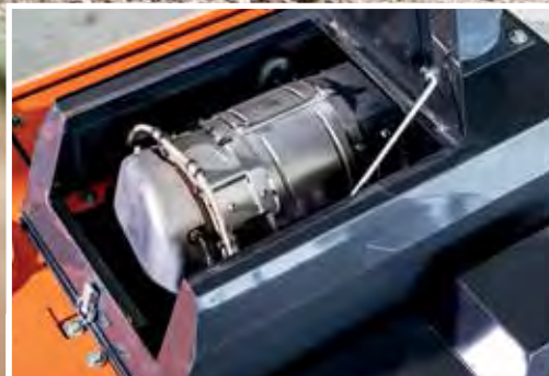
SCR-järjestelmä pienentää päästöjä ja melua.
