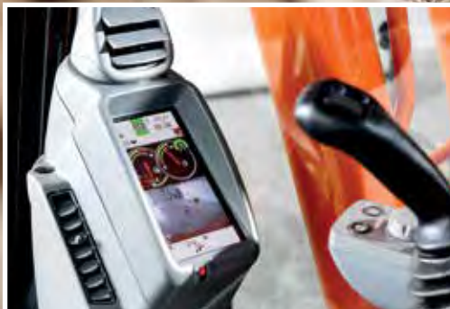
LCD-näytöllä näkyvät koneen tila ja asetukset.
