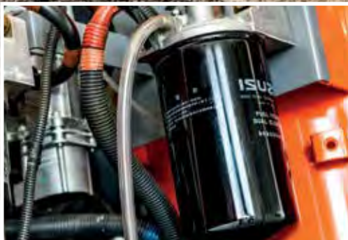
Polttoaineen pääsuodatin on helpompi vaihtaa.
