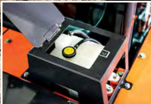
Paisuntasäiliön uusi sijainti estää moottorin ylikuumenemisen.
