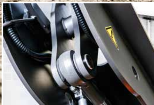
Letkujen ja johdotusten sijoittaminen koteloiden sisään suojaa tärkeitä komponentteja.
