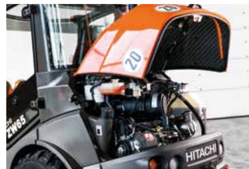
Helposti avattava moottoritilan kansi mahdollistaa nopeat huoltotoimet.
