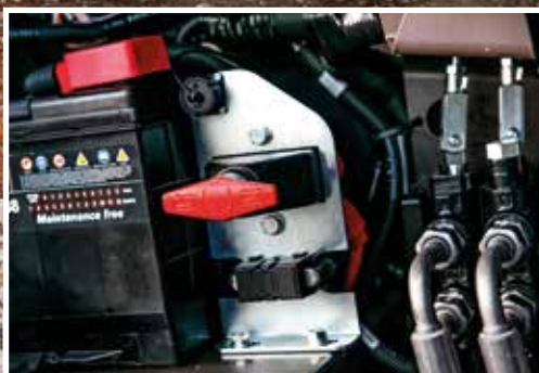
Akun päävirtakatkaisin helpottaa huoltoja.
