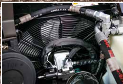
Moottorin jäähdytyspuhallin auttaa vähentämään päästöjä ja parantaa polttoainetaloutta.
