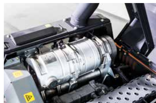
SCR-järjestelmä vähentää päästöjä ja melua.
