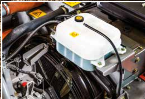
Paisuntasäiliö estää moottorin osien ylikuumenemisen.
