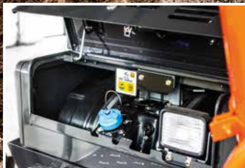
Ureaa ruiskutetaan pakokaasuun päästöjen vähentämiseksi.
