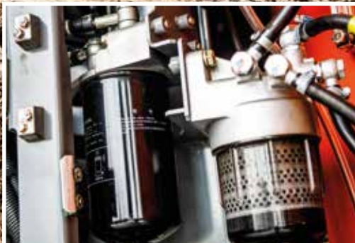
Polttoaineen pääsuodatin on helpompi vaihtaa.
