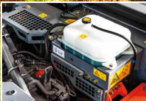
Paisuntasäiliö estää moottorin osien ylikuumenemisen.
