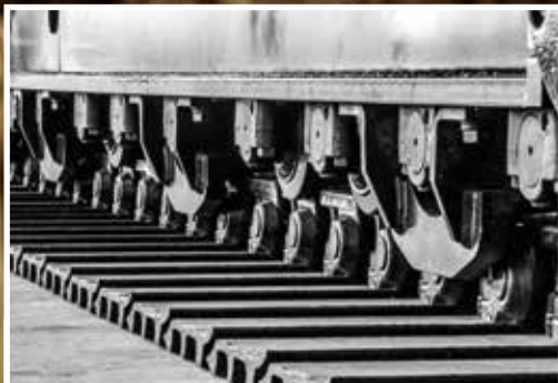
Useampi telaohjuri parantaa telan kestävyyttä.
