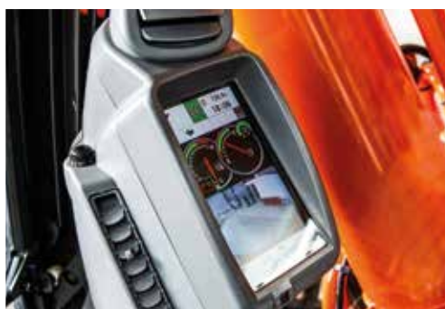
LCD-näytöllä näkyvät koneen tila ja asetukset.
