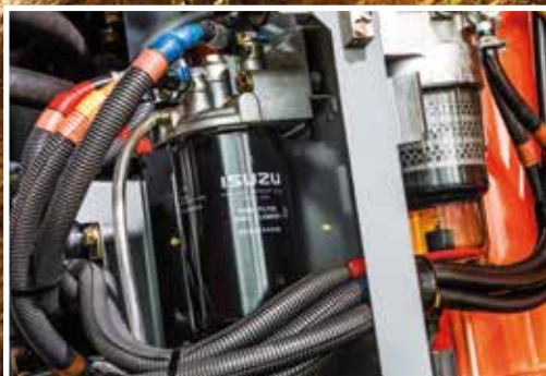
Polttoaineen pääsuodatin on helpompi vaihtaa.
