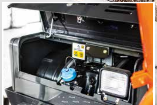
Ureaa ruiskutetaan pakokaasuun päästöjen vähentämiseksi.
