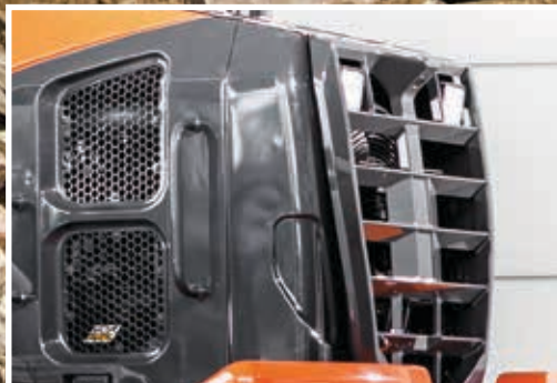
Optiona saatavilla oleva, tukkeutumaton jäähdytyn parantaa kestävyyttä.
