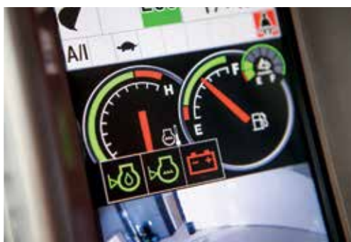
LCD-näytöltä näkee koneen tilan ja asetukset.
