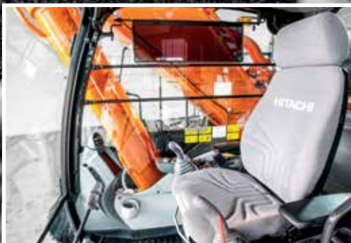
Vähentyneet kuolleet kulmat parantavat näkyvyyttä.
