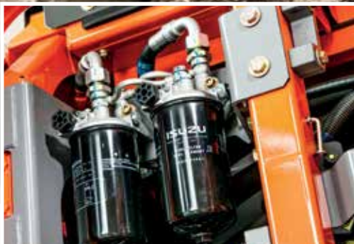
Polttoaineen pääsuodatin on helpompi vaihtaa.
