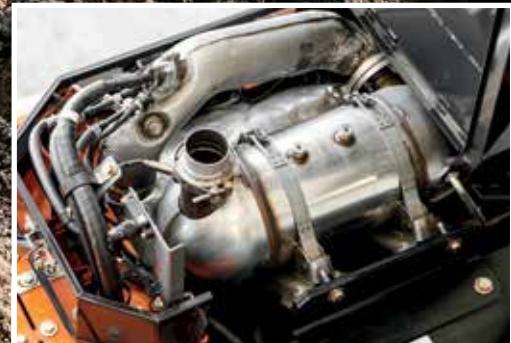
SCR-järjestelmä pienentää päästöjä ja melua.
