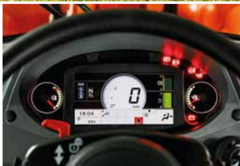
LCD-näyttö näyttää koneen tilan ja asetukset.
