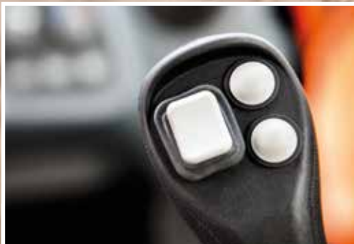
Tehonlisäyskytkin antaa tarvittaessa nopeasti lisävoimaa.
